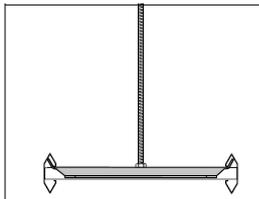
Support console 6 monté sur tige filetée M10 W76. Fixez la console à l'aide d'écrous M10.
